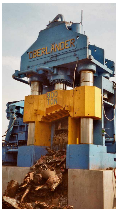
Изображение: Характерные для пресс-ножниц марки Oberländer цилиндрические направляющие.
