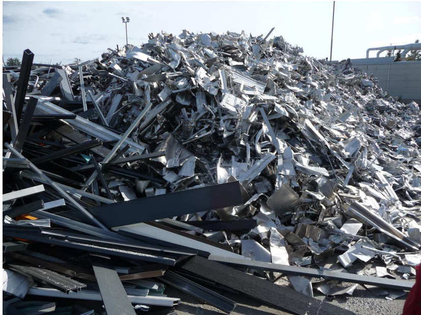
Abb. 1: geschnittenes und ungeschnittenes Shredder Aufgabematerial
